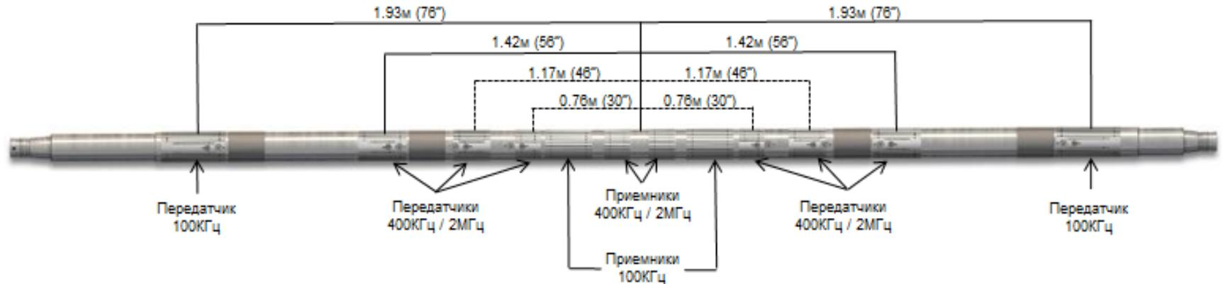
**Для картирования границ используется комбинация фазовых и амплитудных сопротивлений на трех частотах 100КГц, 400ЛГц и 2МГц**
