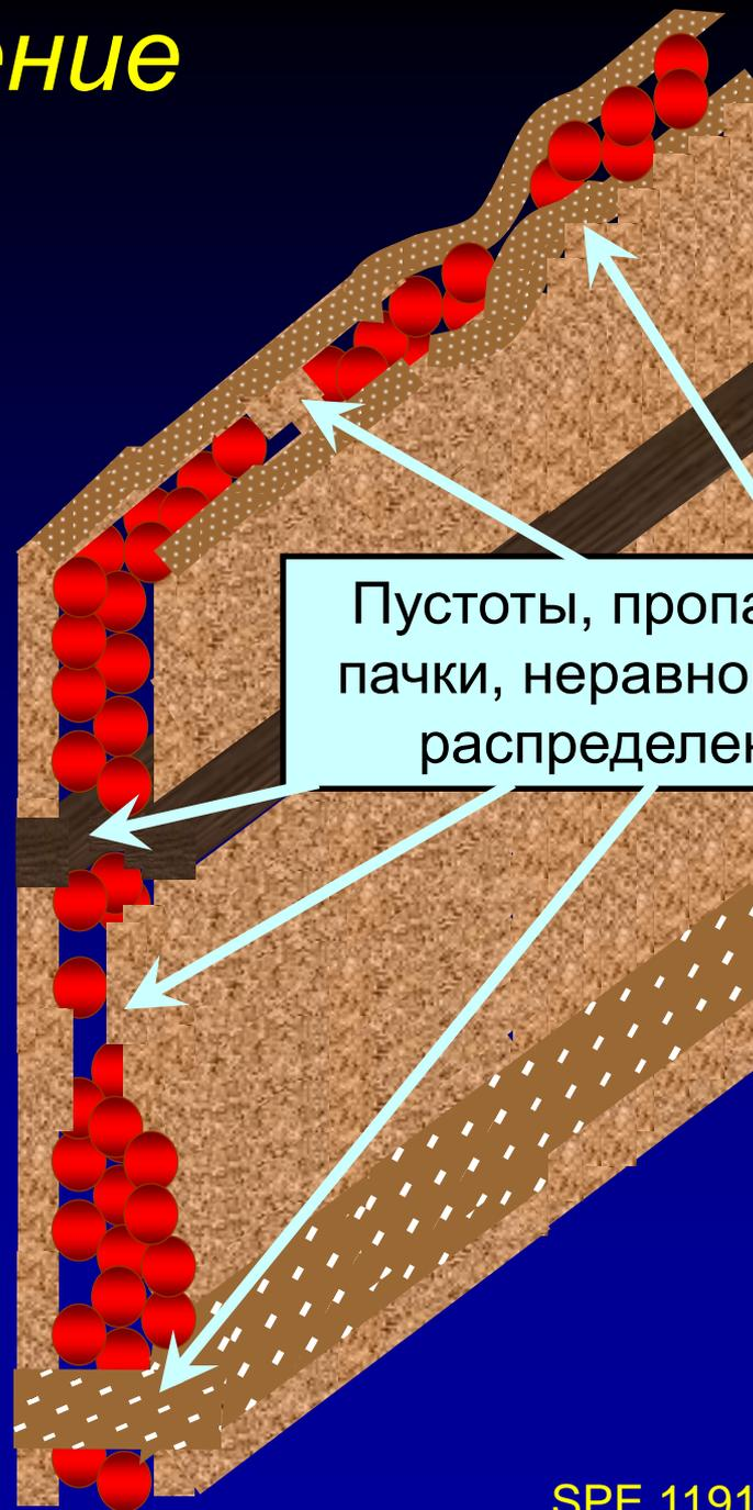
Пустоты, пропантные пачки, неравномерное распределение?
